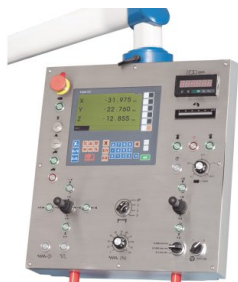
Equipada con volantes electrónicos y funciones de fresado ampliadas, la Servomill ofrece las ventajas de la moderna tecnología CNC en el mecanizado convencional
